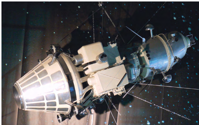
Автоматическая межпланетная станция «Луна-10». В правой части – отделяемый первый в мире искусственный спутник Луны
