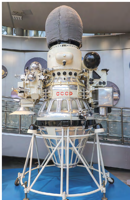
Автоматическая межпланетная станция «Луна-9». В верхней части – закрытая надувными амортизаторами лунная станция, впервые в мире совершившая мягкую посадку на поверхность Луны
