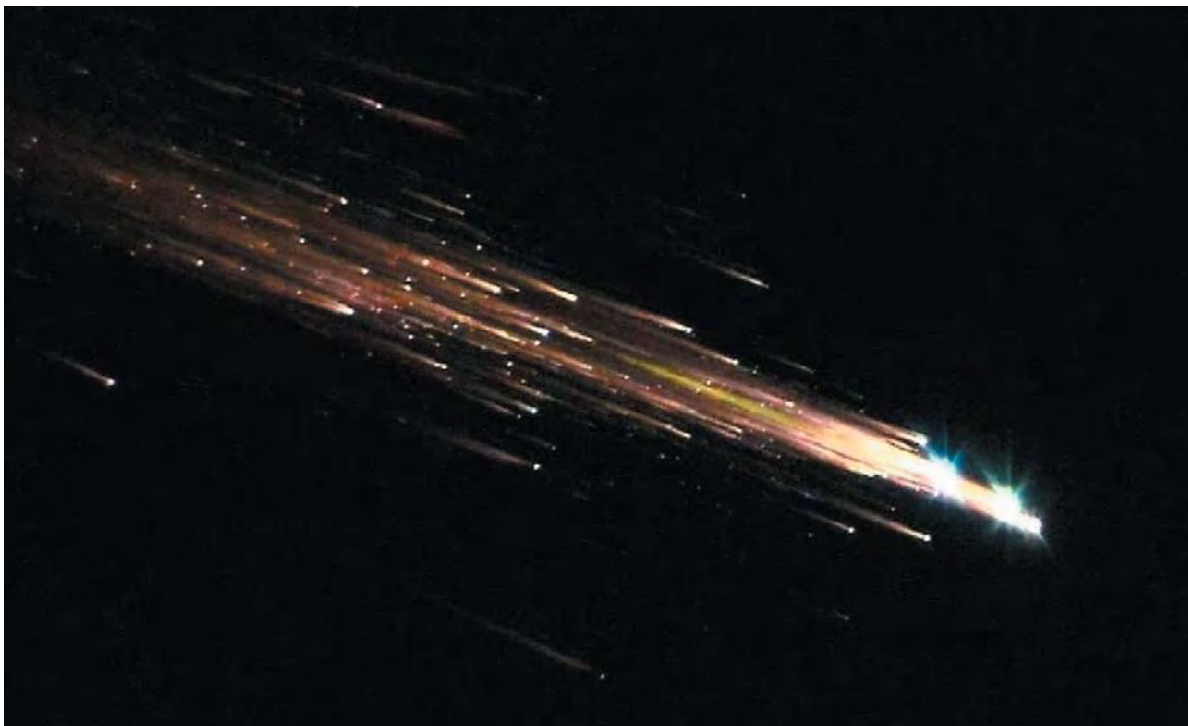
Рис. 19. Вход в атмосферу европейского беспилотного грузового транспортного космического корабля ATV «Жюль Верн» сопровождался появлением яркого болида. Космический корабль разрушился и сгорел в атмосфере, подобно небольшому астероиду
